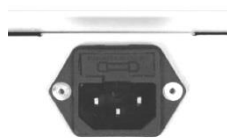
Разъём питания вентиляторного блока с терморегулятором и датчиком
